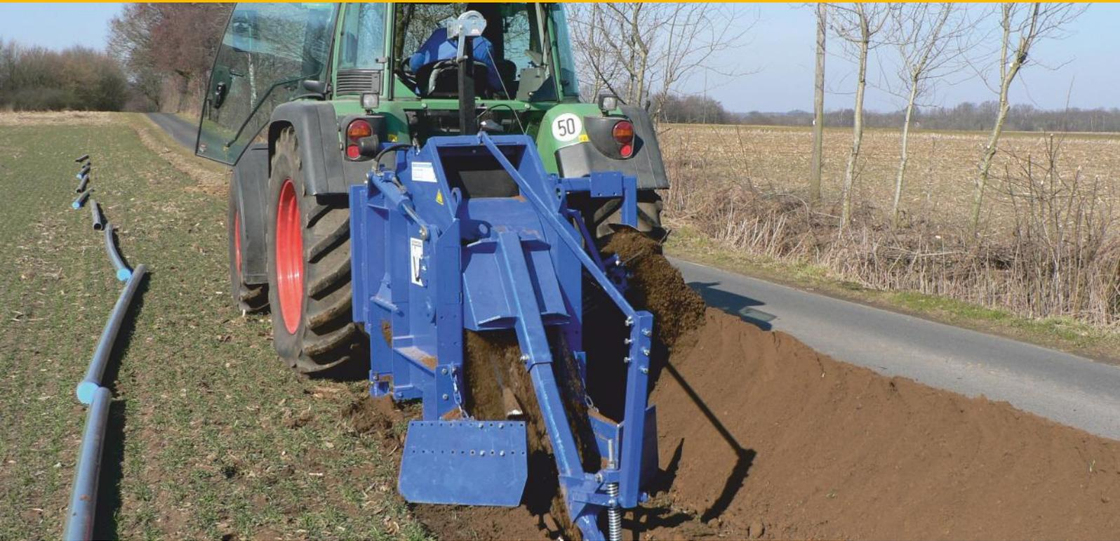
**Kräftig und flexibel.** Die GM 140 AF ist eine Anbaugrabenfräse zur Montage an Schleppern mit Dreipunktaufnahme am Heck. Sie ist ideal zur Kabel-, Rohr- und Drainagerohrverlegung. Um optimal an Hindernissen und Böschungen Arbeiten zu können, lässt sich der Fräsbalken mechanisch oder hydraulisch bis zu 600 mm seitlich versetzen (Optional). Die Fräse kann
